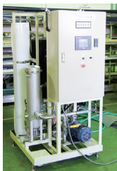
ROろ過装置
